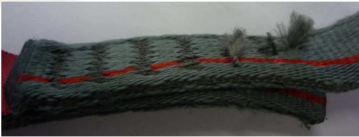
Presenza di tagli e abrasioni sulle cuciture
