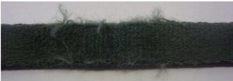
Forte abrasione generalizzata sulla superficie delle fettucce
