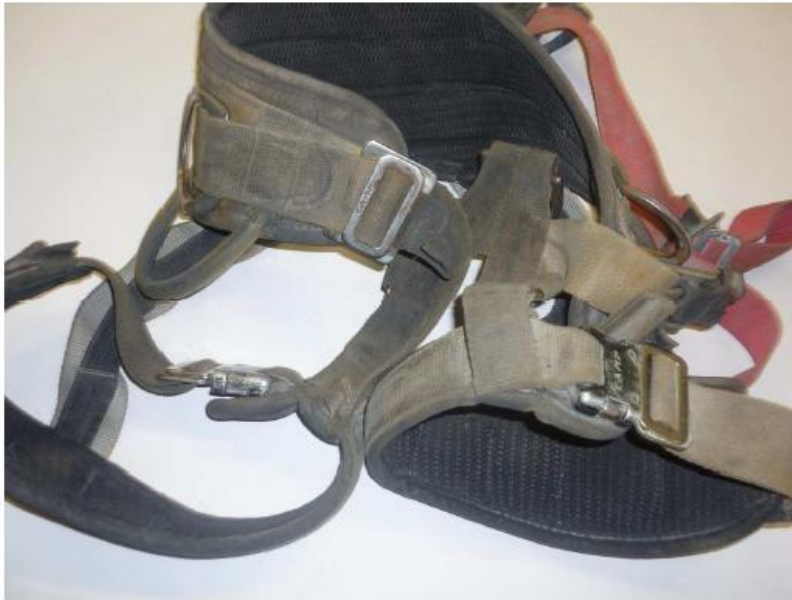
Utilizzo intenso con conseguente usura generalizzata
