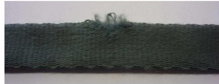
Presenza di tagli localizzati sul bordo delle fettucce
